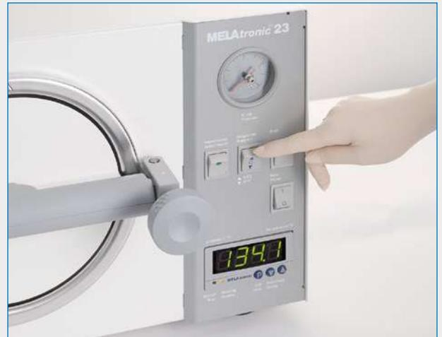
Der MELAtronic®23 verfügt über zwei Sterilisationsprogramme. Für die schnelle Sterilisation von Instrumenten steht das Programm mit 134 °C / 2,1 bar zur Auswahl. Die temperaturempfindlichen Materialien können schonend im Programm mit 121 °C / 1 bar sterilisiert werden.
