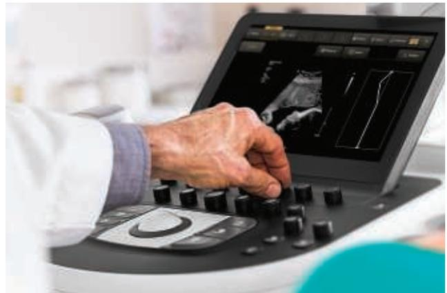
Eine Bildanzeige und TGC-Einstellungen stehen auch auf dem Tablet-Touchscreen des Affiniti 70 zur Verfügung, so dass die Anzahl der Bedienschritte minimiert und der Benutzerkomfort erhöht werden.
