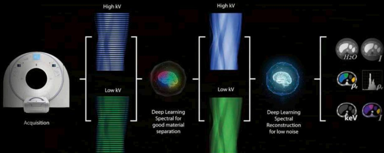
Der Aquilion PRISM nutzt die Deep-Learning-Rekonstruktion gleich zweifach für die spektrale Bildgebung. Zunächst werden die gemessenen Rohdaten, die Sinogramme, in einer ersten Deep-Learning basierten Rekonstruktion vervollständigt (sog. „Datenrestauration“). Im zweiten Schritt werden die rauscharmen Schichtbilder aus den Sinogrammen mithilfe des Deep-Learning-Algorithmus AiCE rekonstruiert. Unmittelbar danach steht eine Vielzahl von Auswertungen zur Verfügung.
